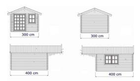
Le plan des façades et des toitures permet d'apprécier quel sera l'aspect extérieur de la construction. Vous indiquerez l'orientation de chaque façade sur le terrain.
